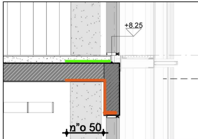
איור מס' 2 – טיפול בגשר תרמי – רצפת ביניים – טיפול חיצוני. דוגמה של גשר תרמי
